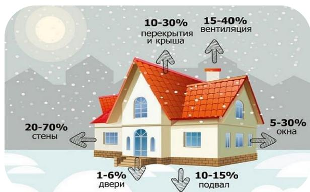
Зимой теплый воздух уходит изнутри здания в окружающую среду через оболочку (ограждающие конструкции) здания. Тепло может уходить через стены, крышу, окна, перекрытия, щели, мосты холода, при плохом качестве изоляции, при недостаточной толщине ограждающих конструкций.
